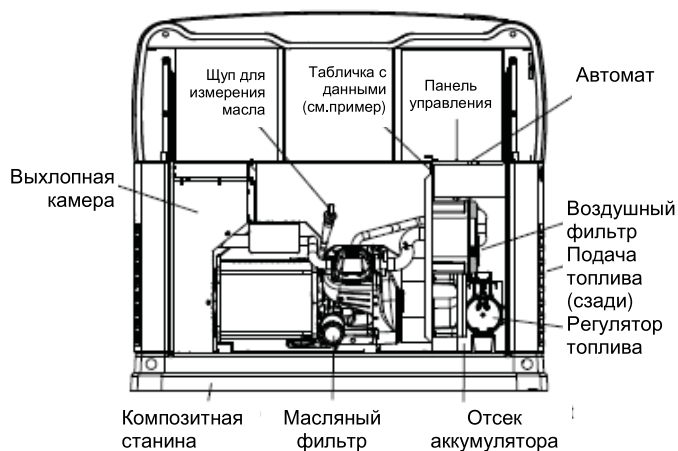
Рисунок 1.2 – 8 кВт, двухцилиндровый V-образный двигатель GT-530 (со съемной дверцей)
