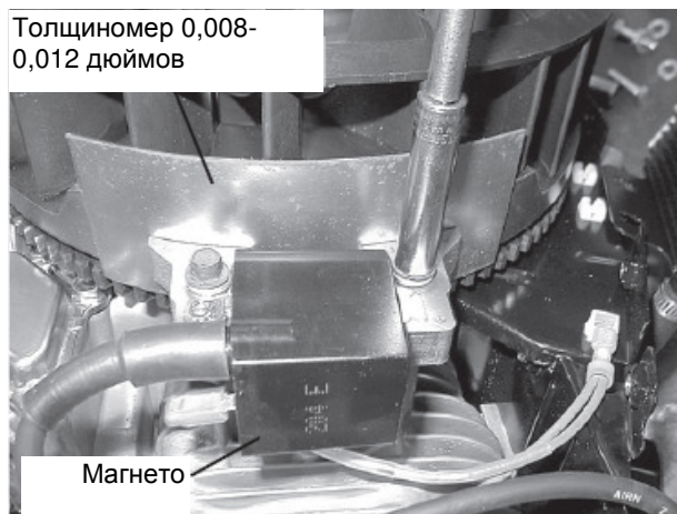
Рисунок 25. Регулировка воздушного зазора магнето (ротора) зажигания
